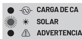
Figura 14: LED 2: SOLAR está PARPADEANDO
