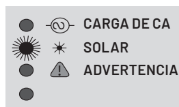
Figura 19: LED 2 - SOLAR está PARPADEANDO
