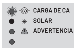
Figura 18: LED 1 - CARGA DE CA está ENCENDIDA
