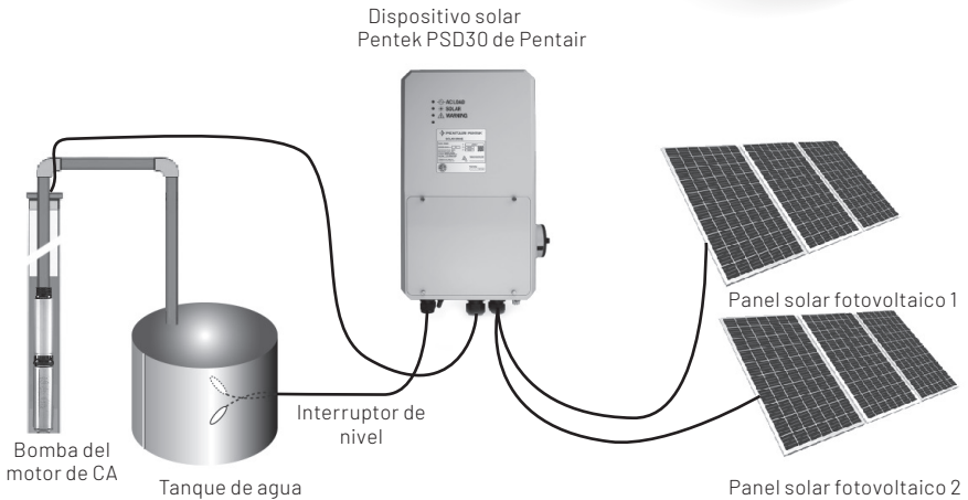
Figura 1: Diagrama del sistema solar de bombeo de agua con el solar drive Pentek de Pentair PSD30
