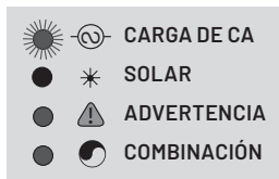
Figura 18: LED 1: la carga de CA está encendida
